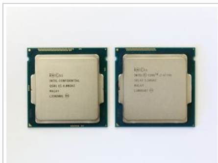
Core i7-4790K[Engineering Sample](左)とCore i7-4770Kの比較。基板上の電極の配置が異なる
