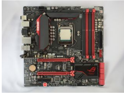
テストに用いたIntel Z97 Expressチップセット搭載マザーボード「ASUS MAXIMUS VII GENE」
